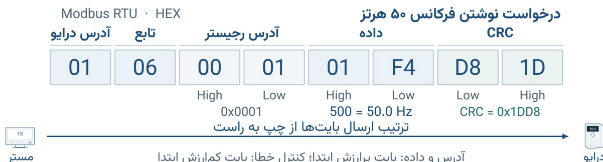
شکل ۴: اجزای فریم نوشتن فرکانس 50 هرتز با تابع 0x06
